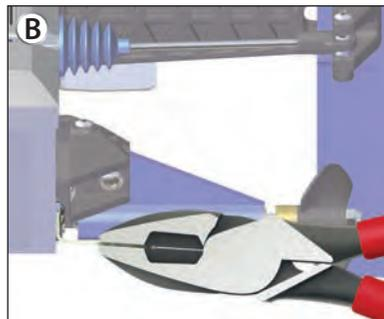
Para ajustar la lengüeta de dirección, sujétela firmemente con unas pinzas lo más cerca posible del codo. Flexione la lengüeta de dirección hacia abajo para establecer un nuevo ángulo. Tenga en cuenta que la lengüeta de dirección se repliega, por lo que necesitará flexionarla un poco más de lo que desea para lograr la posición que busca.
