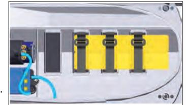
**Baterías en la popa:** Las aguas calmas y el viento suave le permiten mover las baterías hacia atrás en el casco para permitir que la proa se eleve y aumente la velocidad del Spartan SR. Si coloca las baterías más cerca de la popa, aumentará la posibilidad de que el bote se tumbe con la velocidad o se vuelva inestable.
