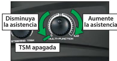
Al conducir sobre superficies con algo de tracción, es posible que desee reducir el ajuste de la TSM para permitir que el vehículo se sienta más "suelto" para variar el deslizamiento y la variación de potencia, y así sucesivamente. En superficies con muy poca tracción (tierra suelta, hormigón liso, hielo/nieve), aumente la TSM para maximizar la aceleración y el control.
