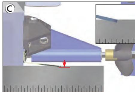
Esta ilustración muestra una deflexión descendente de 1 mm. Este pequeño ajuste implicará un leve cambio en el funcionamiento del casco. La deflexión máxima debe ser de 2 o 3 mm.
