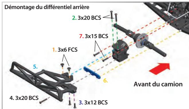
5. Faites glisser l'ensemble de pare-chocs pour le retirer du châssis.
