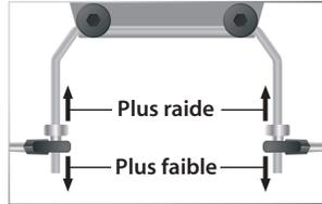
position plus rapprochée du point de pivotement signifie un serrage plus raide, une position plus éloignée du point de pivotement génère une réponse plus faible de la barre antiroulis.
