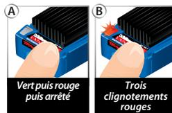
4. Le témoin DEL clignote et puis devient vert constant (le détecteur de basse tension est ACTIVÉ) ou rouge constant (le détecteur de basse tension est DÉSACTIVÉ). Le modèle est prêt à conduire.
