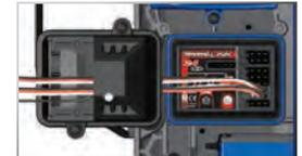
**Note** : Pour un meilleur rendement, nous recommandons que ce récepteur soit installé dans la même orientation que le récepteur original, comme indiqué.
