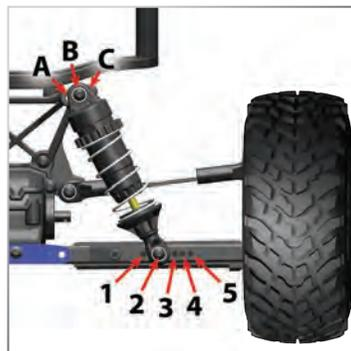
La suspension du modèle est réglée pour tous terrains (la position 2 sur les bras de suspension avant et la position 3 sur les bras de suspension arrière). Si vous envisagez de conduire le véhicule sur des surfaces de roulement dures, il faut effectuer les modifications suivantes :
