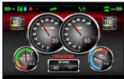
El tablero de instrumentos personalizado de Traxxas Link proporciona datos del rpm, la velocidad, la temperatura y el voltaje en tiempo real.
