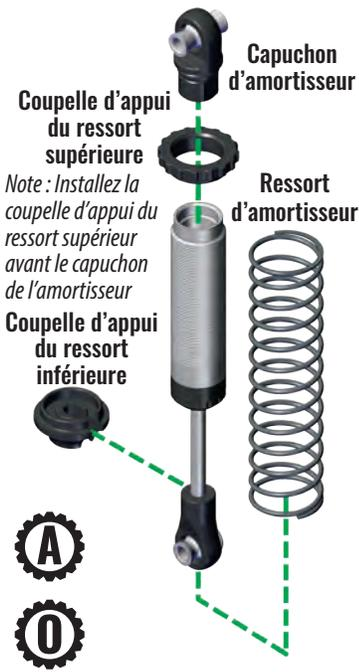
Manipulez l'amortisseur pour vérifier qu'il se comprime entièrement. Si ce n'est pas le cas, il est trop rempli.
