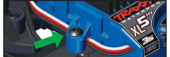
Branchez les raccords boucle du moteur dans l'ESC
