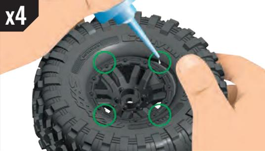
Collez les pneus aux roues. Utilisez votre pouce pour pousser le bord du pneu afin de l'écarter de la roue. Répétez l'action aux quatre points autour de la roue. Retournez la roue et répétez la procédure sur l'intérieur de la roue.
