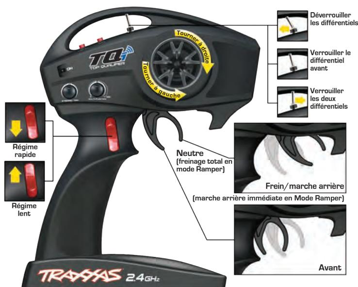
**Note :** Remettez la manette du transmetteur en position neutre et soulevez pour activer l'accélérateur en marche arrière à moins que la contrôleur de vitesse électronique soit en mode Ramper (*consultez la section "Sélectionner le mode d'accélération" pour plus d'informations*).
