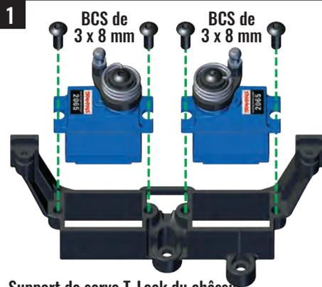
Support de servo T-Lock du châssis
