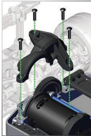
Pour régler l'engrènement, utilisez le tableau à gauche pour identifier les positions des vis sur la plaque du moteur (A - K) qui correspondent aux dimensions choisies des engrenages à pignons du moteur. Retirez les deux vis de la plaque moteur et réinstallez-les dans les positions correspondantes, puis réinstallez l'ensemble de la plaque moteur sur le châssis.
