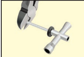
D. Installation/enlèvement du piston
