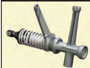
A. Ajuste/afloje la tapa superior
