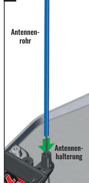
Achten Sie darauf, den Antennendraht nicht zusammenzuquetschen, wenn Sie ihn in das Antennenrohr schieben.
