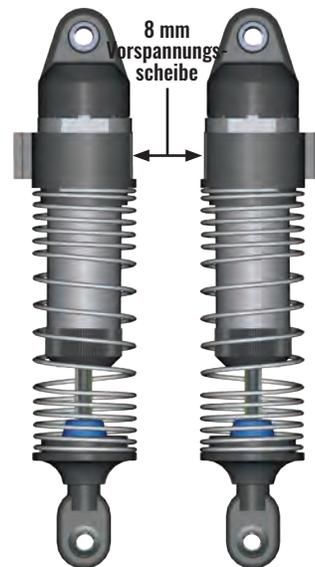
\*8 mm Vorspannungsscheibe und Anschlagpuffer nur an den hinteren Stoßdämpfern
