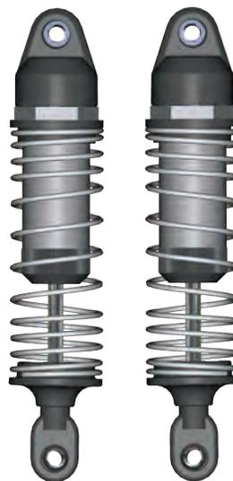
Hintere Stoßdämpfer, montiert
