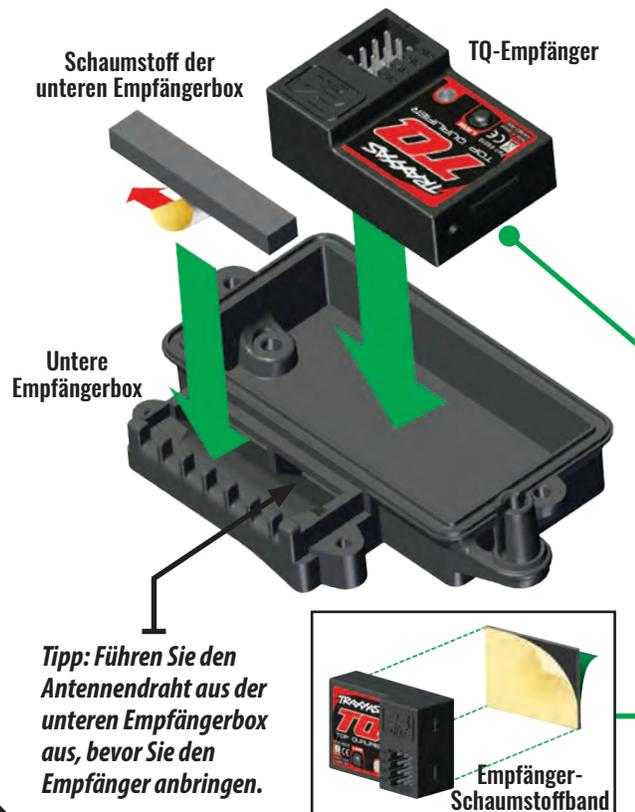
Den Antennendraht durch die
