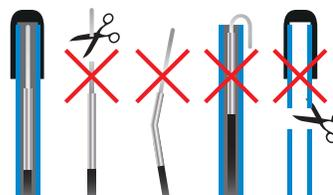
Ziehen Sie den Antennendraht nicht zu fest an und zerdrücken Sie ihn nicht. Bitte das schwarze Kabel nicht scheiden oder knicken, die Metallspitze nicht biegen oder abschneiden und das weiße Kabel am Ende der Metallspitze nicht biegen oder abschneiden. Den Antennendraht nicht kürzen.
