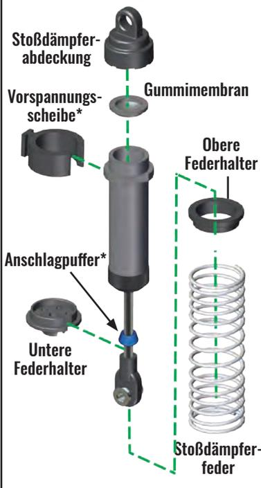
Betätigen Sie den Stoßdämpfer, um sicherzustellen, dass die Welle vollständig zusammen gedrückt wird. Falls nicht, ist zu viel Öl eingefüllt.
